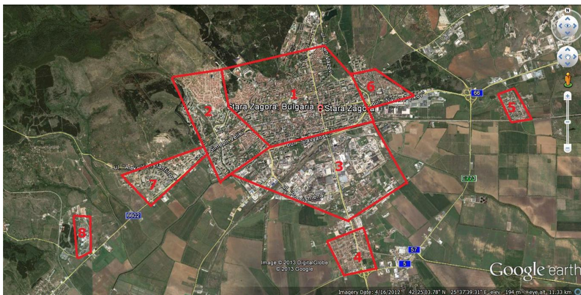
Фигура 4.2 Разделяне на града на зони с оглед определяне на емисиите от битовото отопление
